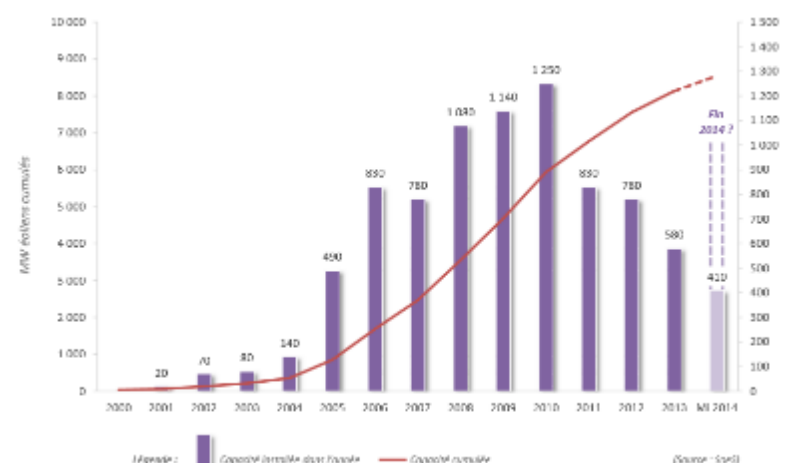
Figure 23 : Évolution de la capacité éolienne installée en France (SoeS in Observatoire de l'éolien - 2 octobre 2014)
